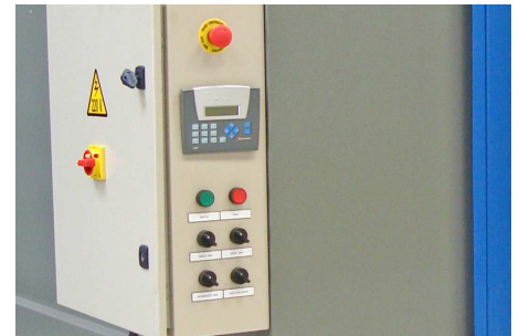
S-250 keyboard for drying process controlling. S-250 panel de control para el proceso de secado
